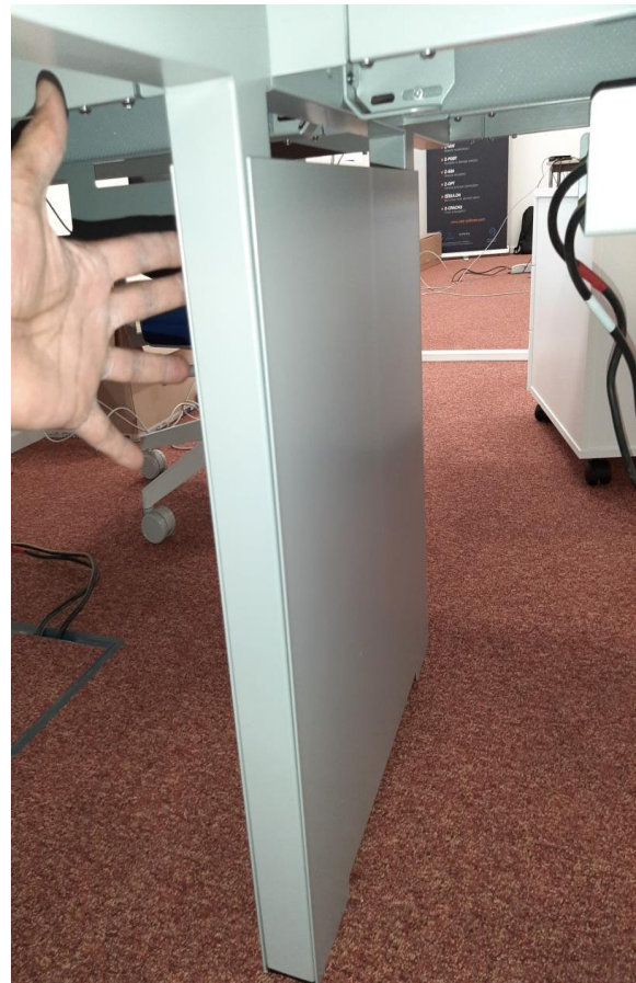
16) Poser, ajuster et visser les plateaux (Attention au niveau du pied intermédiaire visser les plateaux avec des vis 6/16 mm maximum sous peine de transpercement du plateau si utilisation de vis trop longues)
