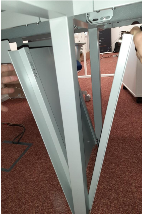
15) Mise en place du carter de finition avec aimant sur le pied intermédiaire
